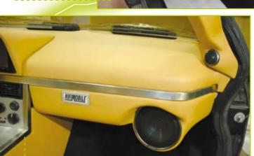
Cette fois, ça y est : le tableau de bord est terminé, avec gros plan sur les haut-parleurs latéraux et le tweeter correspondant, installé sur le pied du montant de pare-brise.
