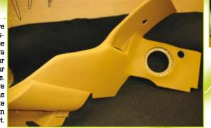
Il est temps de s'attaquer au caisson de grave. Celui-ci prend place à l'arrière, au centre, juste devant les deux amplis qui sont maintenant installés.
