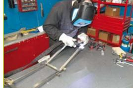
Et, pour la première fois dans nos articles, nous voyons Julio travailler le métal. Il va en effet fabriquer un véritable mini-châssis tubulaire interne, du tableau de bord à la partie arrière, en passant par la console centrale.
