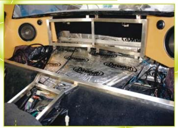
Petit coup d'œil vers l'arrière, pour constater que les deux amplis bénéficient également d'un support tubulaire. Notez les deux voies arrière déjà terminées, et l'utilisation intensive de matériau amortissant Dynamat.
