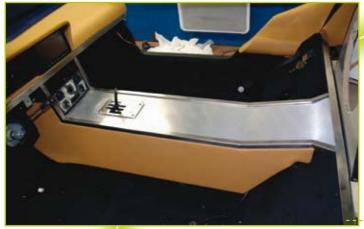
Le revêtement de la console dégage le support tubulaire chromé, et met parfaitement en évidence la grille de la boîte de vitesses, plantée au centre.
