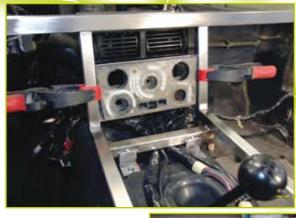
Au centre, devant la console, il faut carrément redessiner le panneau de commande de la climatisation, que l'on voit ici totalement nu et inséré dans la nouvelle structure tubulaire.
